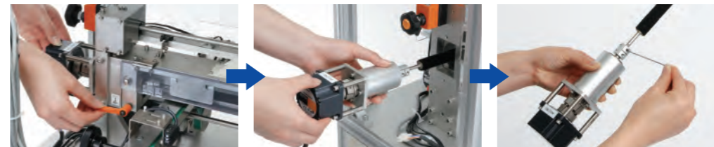
①ロックを外す ②ブラシユニットを引き抜く ③ブラシを外す
